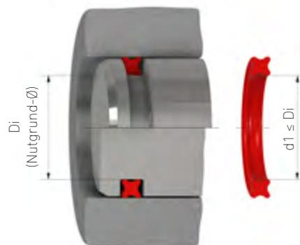
Bild 4.5: Radialeinbau – außendichtend
