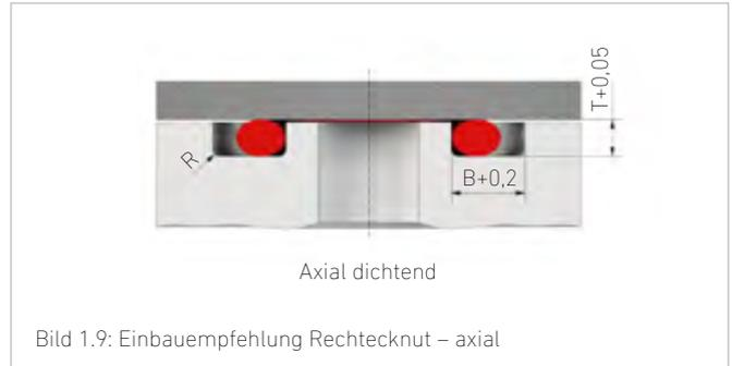
Bild 1.9: Einbauempfehlung Rechtecknut – axial
