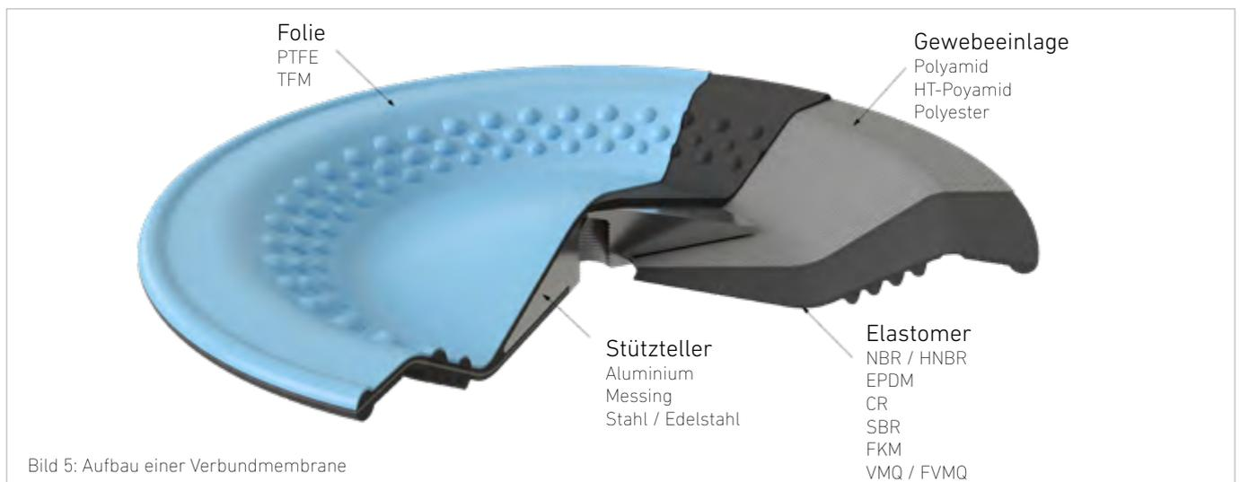
Die PTFE Folie wird chemisch mit der Elastomermembrane verbunden und bildet eine zum Medium in sich geschlossene Oberfläche. Auf diese Weise wird der Elastomerwerkstoff vor aggressiven Umwelteinflüssen geschützt.
