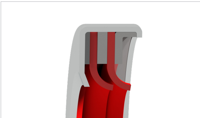
Abb. 3: RWD Bauform RR, Ausführung 1, mit zwei Dichtlippen in Tandemanordnung, für Anwendungen mit erhöht kontaminierten Medien geeignet.
