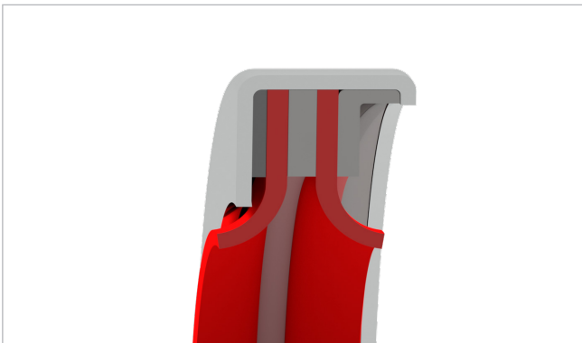
Abb. 4: RWD Bauform RR, Ausführung 2, zwei Dichtlippen in Back-to-Back-Anordnung, für die Trennung zweier Medien geeignet.
