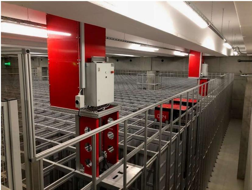
Zum Kommissionieren greifen akkubetriebene Roboter auf das individuell benötigte Lagergut zu und transportieren die Teile in Windeseile von A nach B.
